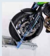
**Funzione del carrello ruota anteriore:** la ruota anteriore viene semplicemente spinta sul blocco ruota. Quando il pneumatico è completamente sul carrello, bloccare la parte anteriore della motocicletta e tirarla nell'area di carico. A questo punto è sufficiente bloccare la parte posteriore.
